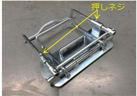
⑤カシメ作業の際、つかみレバーを調整バーに干渉させる事でつかみ量（締め付け角度）を調整します
