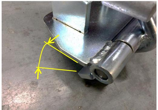
⑦調整バーの固定位置により、ツカミ量（締め付け角度）が変わります現場に合わせて、調節してください
